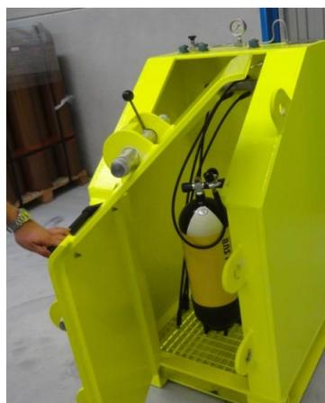
11. Al cerrar la puerta quedará activado el final de carrera que permitirá el paso del aire a presión a las botellas del armario.
