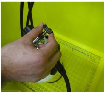
8. En los latiguillos que estén conectados a las botellas se cerrará la purga y se abrirán las válvulas de las botellas y grifería
