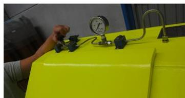
13. Controlar el incremento de presión de entrada en el manómetro situado en la parte superior. Debe vigilarse la presión para comprobar que no se sobrepasa el valor de carga.
