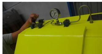
16. A continuación se procederá a abrir la puerta del armario mediante los pasadores, primero abriremos los inferiores y después el superior.
